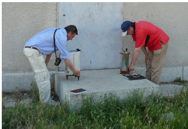
Фиг. 1. Гравиметрични измервания с гравиметри Scintrex CG-5 и GAK 7T
